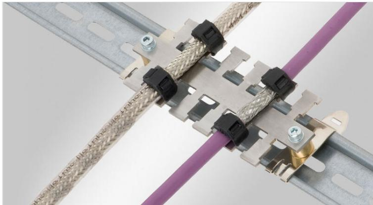
I listelli antistrappo EMC KAFM permettono il fissaggio dei cavi e contemporaneamente assicurano un contatto di massa a bassa impedenza per lo schermo dei cavi per la soppressione dei disturbi.
